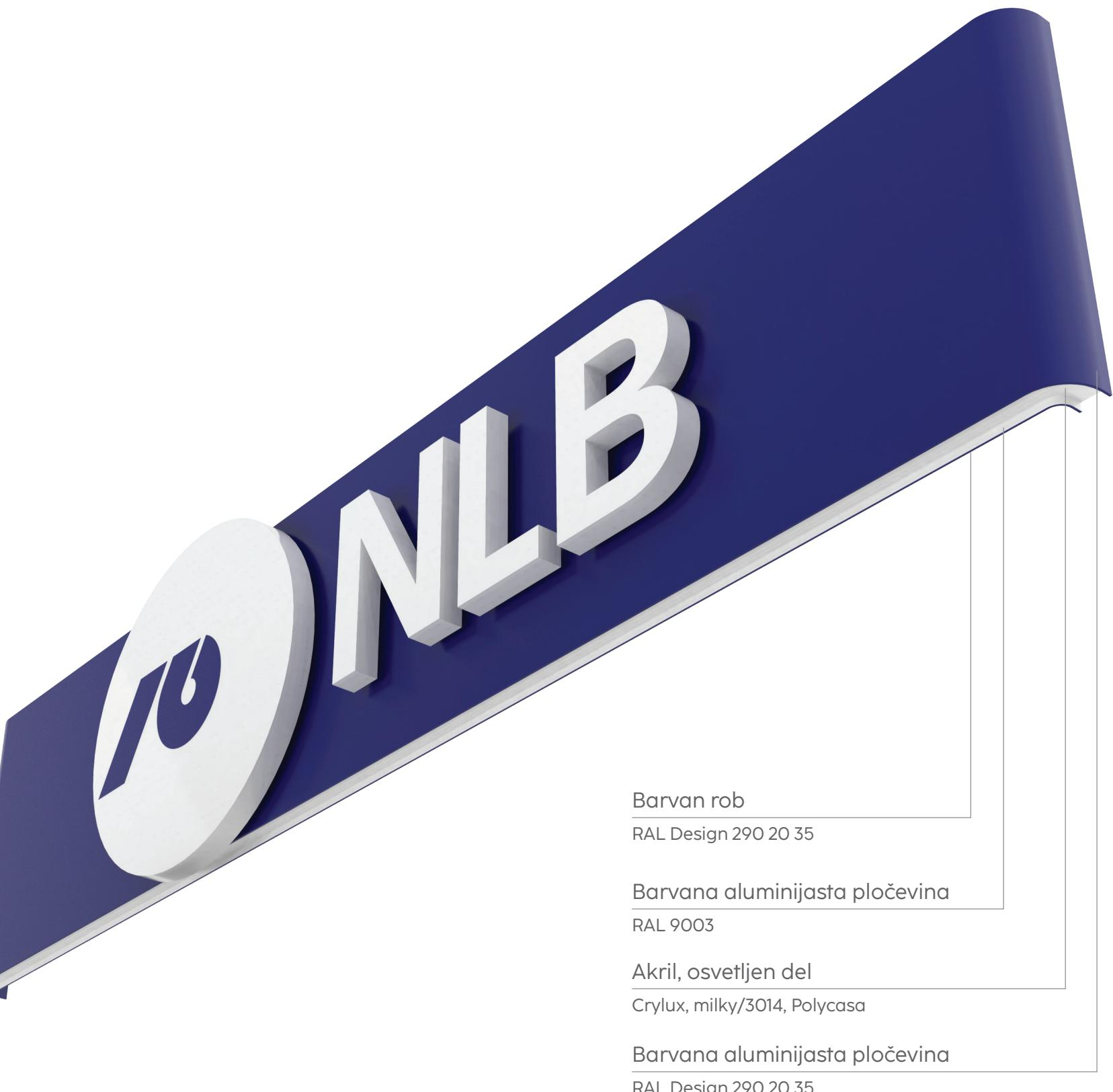
Svetlobni elementi, ki so izdelani iz barvane **aluminijaste pločevine** in **akrila**, so izdelani na način, kot je prikazano na levih vizualizacijah.
